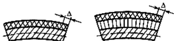
Рис. 3.2. Характер деформации жесткого ВДП: \Delta – деформация демпфируемого слоя
