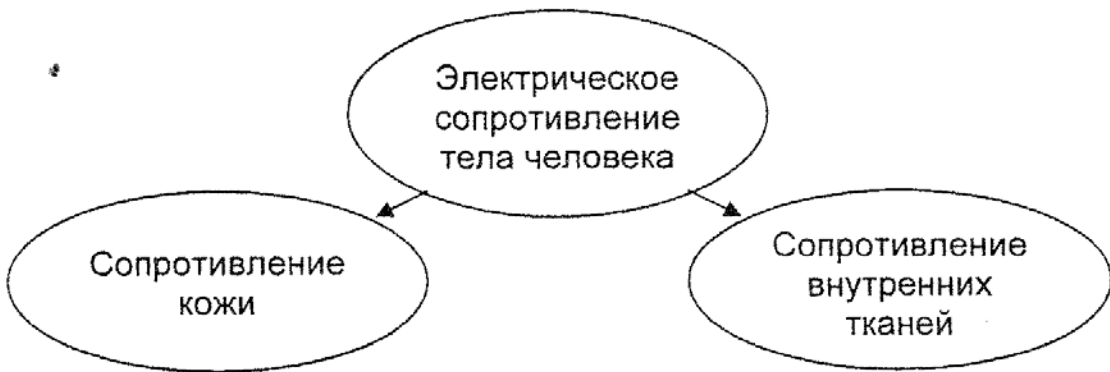
Рис. 4. Составляющие электрического сопротивления тела человека
